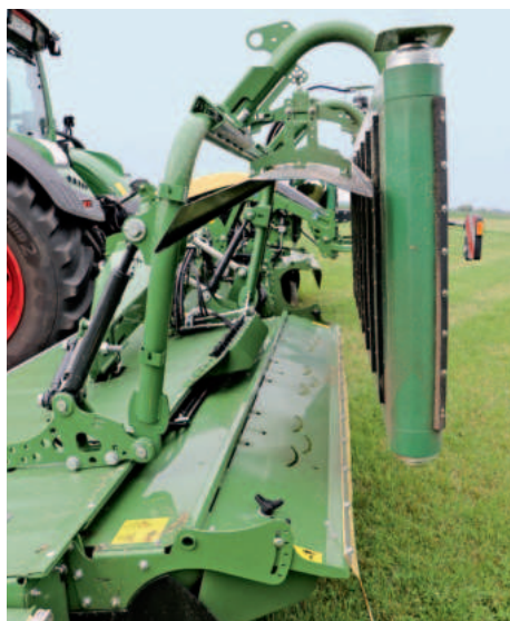
Für die Breitablage werden die Förderbänder hydraulisch aus dem Futterstrom geschwenkt.
