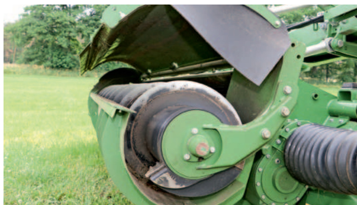
Die nachrüstbare Förderschnecke wird mechanisch über den Aufbereiter angetrieben und sorgt für eine zuverlässige Schwadablage.
