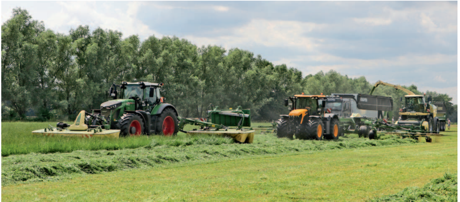
Das System Teilbreitablage bei einer Vorführung: Es lassen sich zwei Mähbreiten zu einem Schwad formen, den der Häcksler auf den Hänger fördert.
