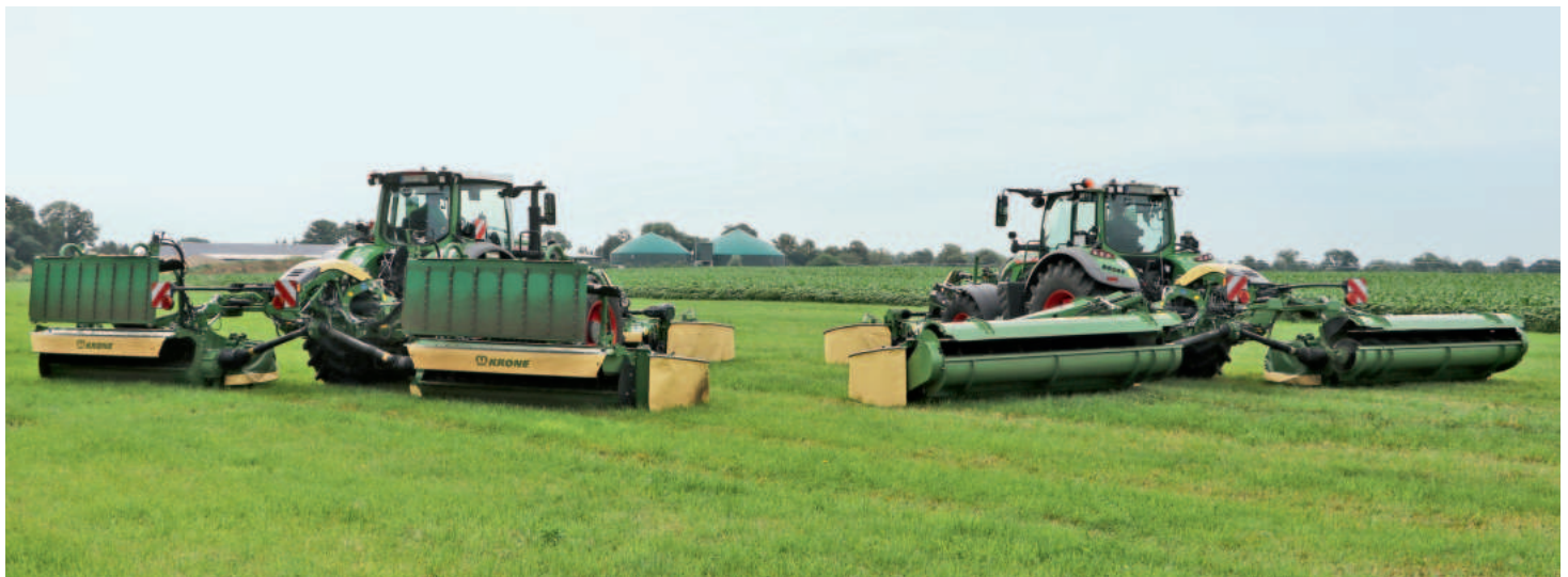
Das Butterfly-Mähwerk B 1050 CV von Krone gibt es in zwei Versionen: einmal mit hydraulisch angetriebenen Querförderbändern und einmal mit mechanisch angetriebenen Förderschnecken. Zusammen mit dem 4-m-Frontmähwerk mähen sie bis zu 10,45 m auf einmal.
