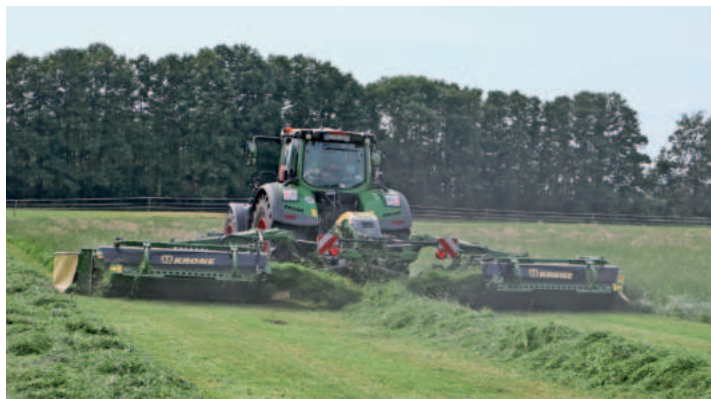
Das Futter der Seitenmäherwerke wird auf das Futter des Frontmäherwerks abgelegt. Die Collect Maschine ist sehr flexibel in der Schwadbreite.
