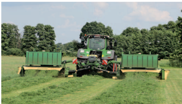
Durch das Hochklappen der Förderbänder kann das Aufbereitermähwerk das Gras breitablegen, die Bänder schalten sich automatisch ab.
