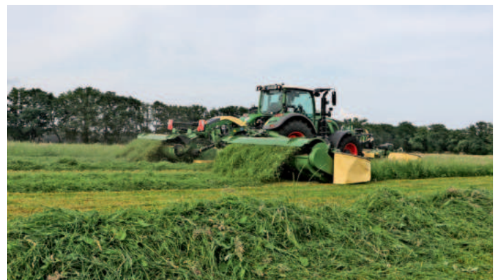
Nach dem Öffnen der Hauben fördert das B 1050 CV BSS das Futter über die Schnecke für die Breitablage.
