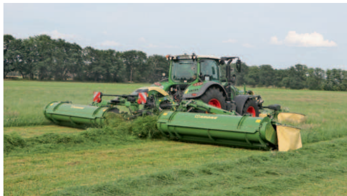
Mit den geschlossenen Schneckenhauben wird das Futter von bis zu 10,45 m auf einen Schwad gelegt. Die Arbeitsbreite beeinflusst die Schwadbreite.
